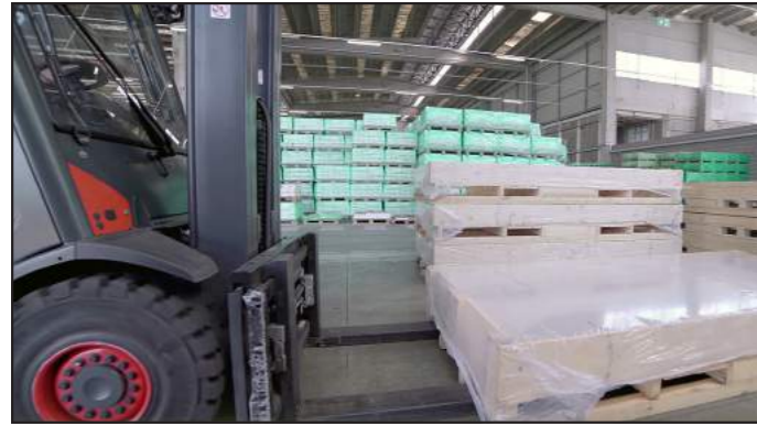
Casse: utilizzo di forche min. 2 m. per presa parallela al lato lungo. Muletto min. 3 t.
