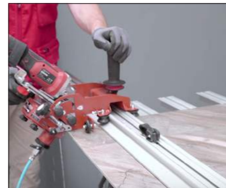
Per taglio lineare/jollatura con smerigliatrice utilizzare disco diamantato.
