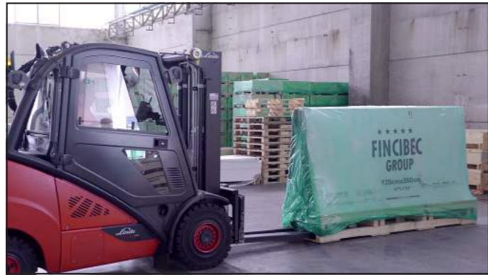
Cavalletti: utilizzo di forche min. 2 m. per presa parallela al lato lungo. Muletto min. 3 t.
