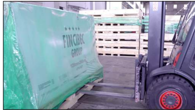
Cavalletti: utilizzo di forche min. 1,2 m. per presa parallela al lato corto. Muletto min. 3 t.
