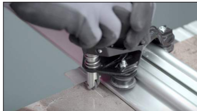
Per taglio lineare a spacco utilizzare appropriata guida di taglio con incisore con rotella a carburo di tungsteno.
