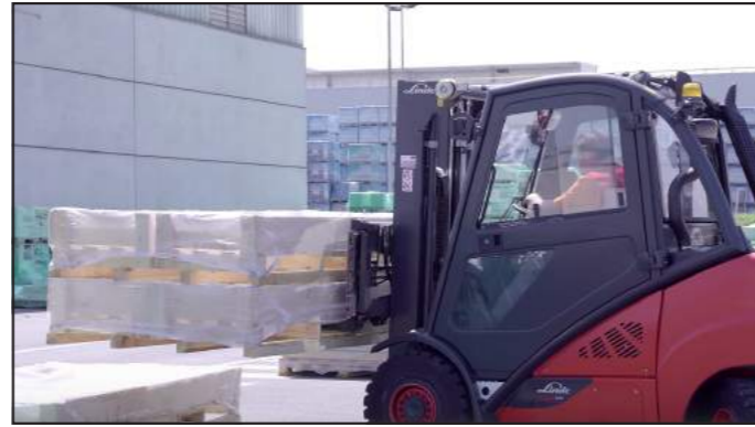
Casse: utilizzo di forche min. 1,2 m. per presa parallela al lato corto. Muletto min. 3 t.
